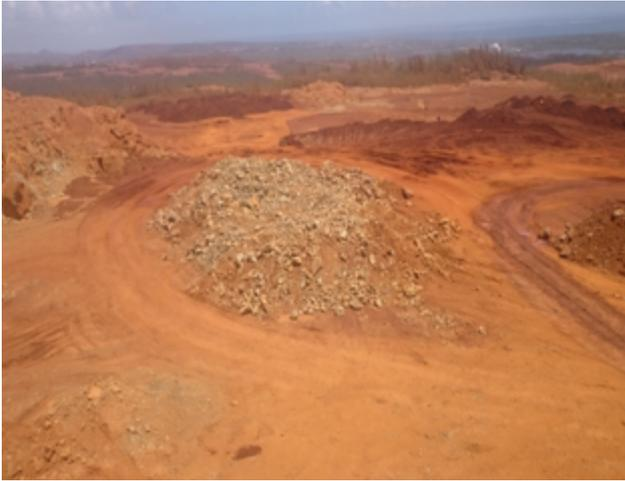
**FIGURA 10.** Rechazo serpentinitico resultante de los procesos mineros en la industria metalúrgica del Níquel en Moa.
